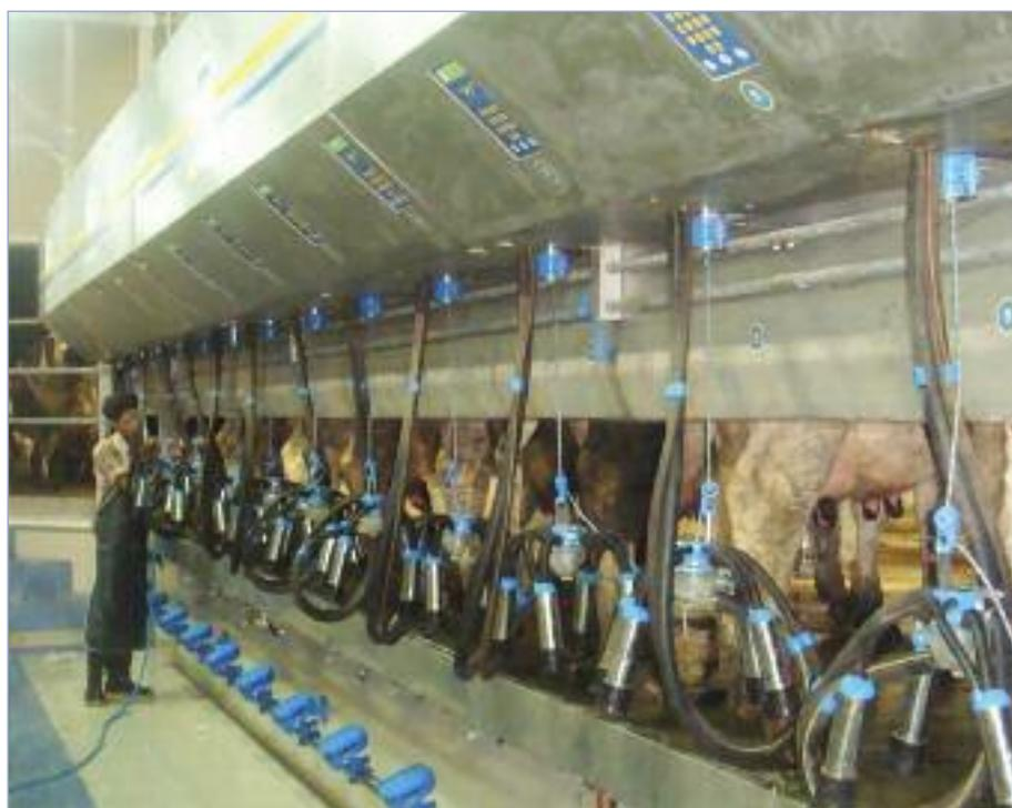
«Дабл Гард» является дополнительной опцией для доильных залов типа «Свифт Фло Дабл» и представляет собой защитный короб из нержавеющей стали, в который помещаются молокопровод и линия пульсации. Внутри короба также устанавливаются либо автономные автосъемники аппаратов, либо счетчики молока, оставляя снаружи только пульт управления для оператора. «Дабл Гард» защищает и ограждает оборудование, и его конструкция обеспечивает легкий доступ для проведения сервисных работ.
