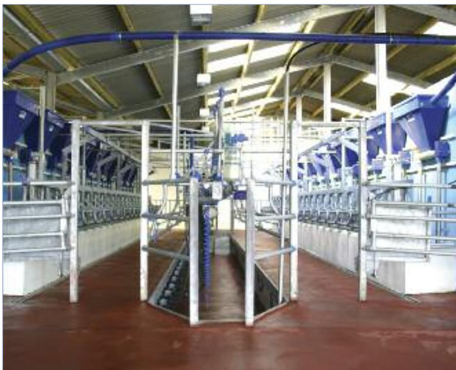
Преимуществами доильного зала «Свифт Фло Свинг» является более свободное пространство доильной ямы, что обеспечивает более комфортную работу оператора. Молочные шланги короче, что позволяет улучшить дойку, сократить эксплуатационные затраты и обеспечить оптимальное положение аппарата на вымени. Промывочная линия с системой «Аква Джетс» располагается под кромкой доильной ямы. Этот доильный зал позволяет значительно сокращать трудозатраты, поскольку большинство задач выполняются автоматически.
