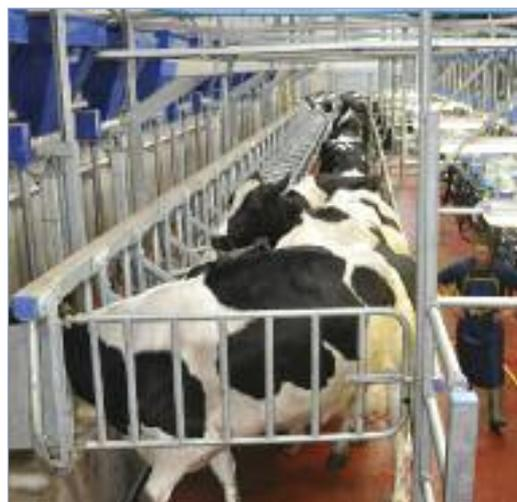
Оператор может управлять подъемными стойлами «Свифт Фло» из любой точки доильной ямы. Подъемные стойла «Свифт Фло» полностью оцинкованы и обладают исключительно прочной конструкцией. Управление стойлами производится при помощи сжатого воздуха, что увеличивает надежность и точность работы.
